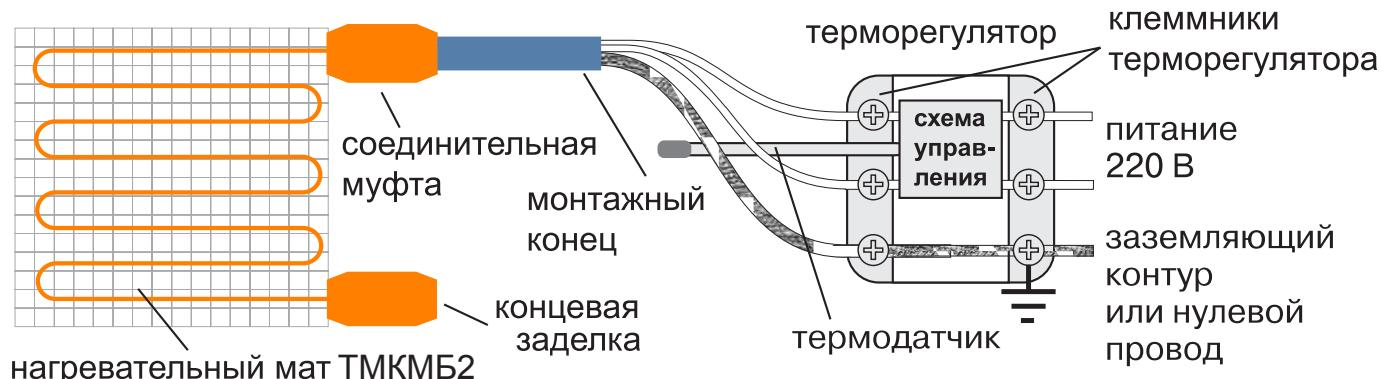
**Изолированные белые провода** монтажного конца соединены с нагревательными жилами кабеля и подключаются к терморегулятору. Провод экранирующей оплетки монтажного конца соединен с защитным экраном нагревательного кабеля. Этот провод необходимо подключить к заземляющему контуру здания (или нулевому проводу).
