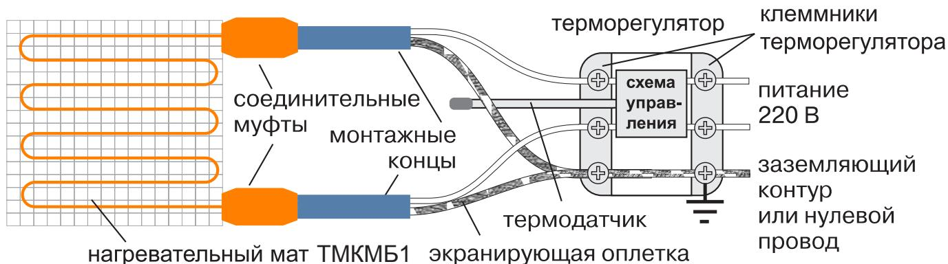
**Изолированные белые провода** монтажных концов соединены с нагревательной жилой кабеля и подключаются к терморегулятору. Провода экранирующей оплетки монтажных концов соединены с защитным экраном нагревательного кабеля. Эти провода необходимо подключить к заземляющему контуру здания (или нулевому проводу).
