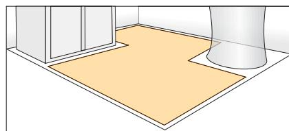
1. Определить площадь обогрева и выбрать мат, площадь которого примерно совпадает с площадью обогрева.
