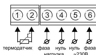
Терморегулятор позволяет экономить электроэнергию, путем включения / отключения нагрузки при помощи датчика температуры, установленного в полу.
